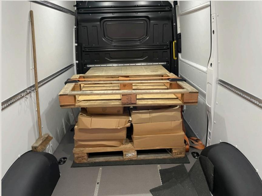
Sicherung eines Lademittelträgers mit nicht allzu empfindlicher Ware. Da hier keine Folie zur Verfügung stand und die Ware nicht Druckempfindlich reagiert, konnte die Palette mit Spanngurten entsprechend gesichert werden. Durch den oberen Abschluss mit einer Palette kann der Druck gleichmäßig auf die Ware verteilt werden.
