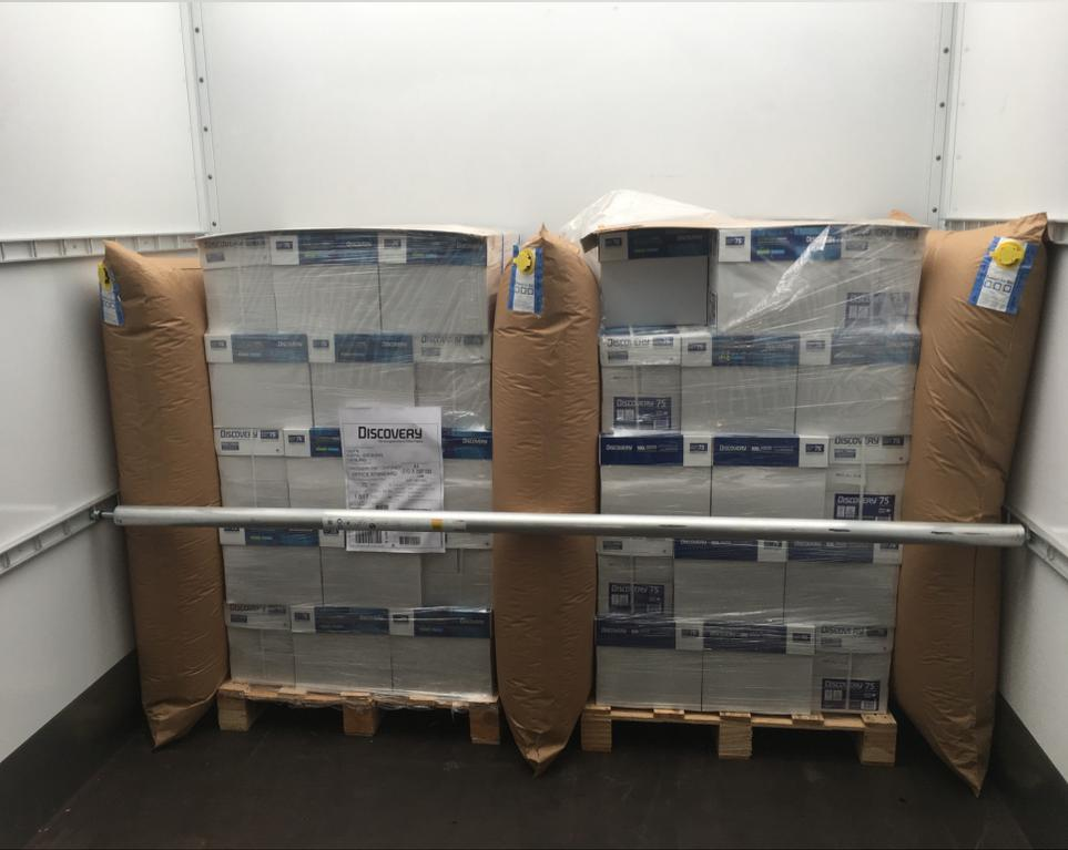
Bei dieser Art der Ladungssicherung erreichen wir die Sicherung durch Formschluss.
